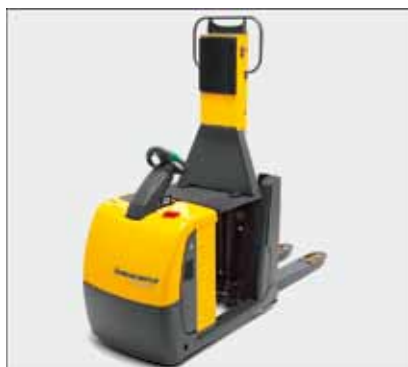
Plukning fra andet reolniveau med ståplade, der kan hæves.
