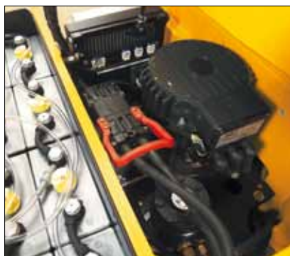
Køre- og løftemotor i vekselstrømsteknik
