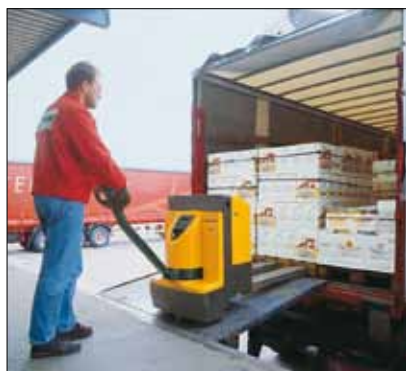
Stabil kørsel med affjedrede støtteruller
