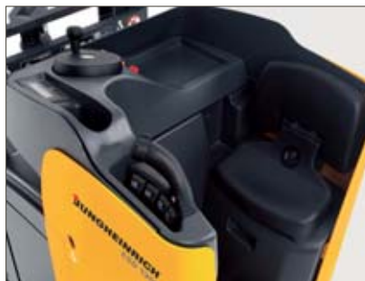
Ergonomische Fahrerplatzanordnung beim ESD 120
